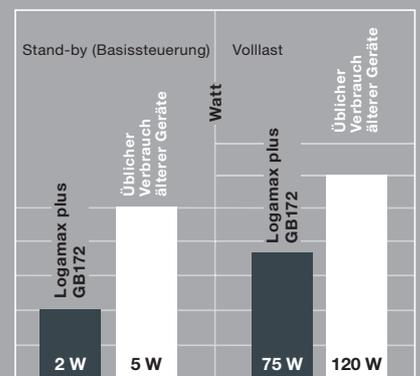
Heizungen verbrauchen neben Brennstoff auch Strom – und auch der wird immer teurer. Dank optimaler Energienutzung sparen Sie mit dem Logamax plus GB172 auch hier bares Geld.
