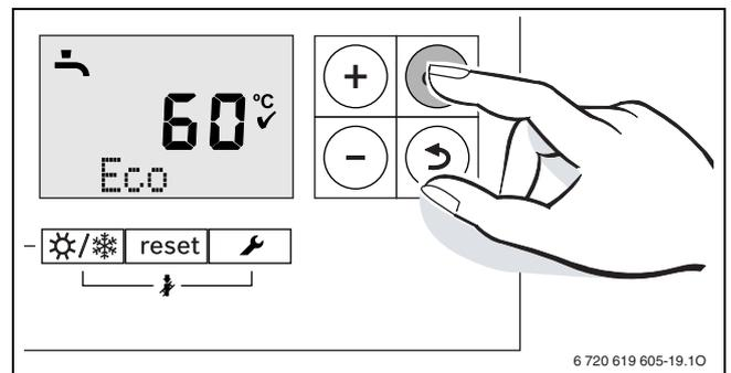
Bild 13 Anzeige Ecobetrieb
