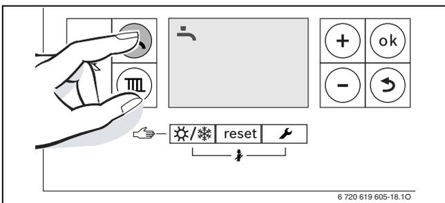
Bild 18 Anzeige Warmwasserbetrieb
